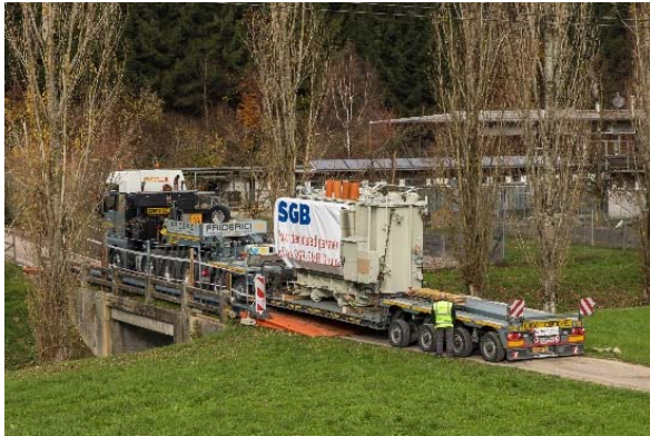
Mit einem spektakulären Transport wurde kürzlich der 55 Tonnen schwere Transformator zur Unterstation Dierikon gebracht. Dazu war bei der Ron eine Brückenverstärkung notwendig.
